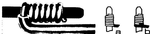
Sl. 5. Povečana slika trna ovitega z žico a) običajno ovijanje b) modificirano ovijanje
