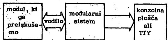
Slika 1. Bločna shema za funkcionalno preizkušanje modulov
